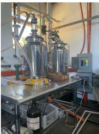
Figura 3. Destilación por arrastre de vapor en alambique de laboratorio.
