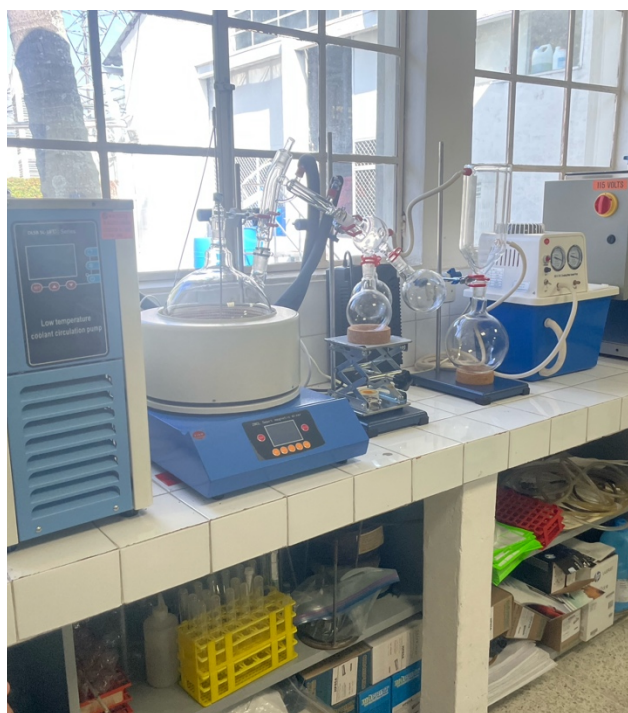
Figura 5. Extracción de aceite esencial de tomillo con pretratamiento enzimático.
