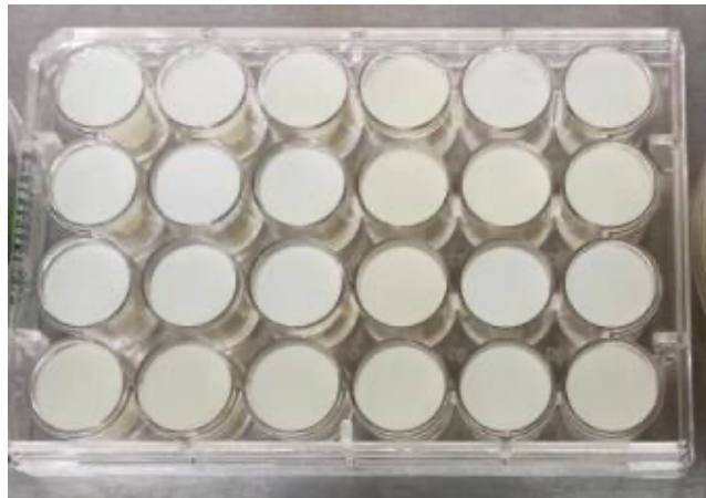
Figura 6. Placa de 24 pocillos con risers. La presente figura muestra cómo quedaron las placas de 24 pocillos previo a la inoculación del hongo. Contó con risers o cilindros de silicona para disminuir la profundidad de manera que, no se necesitara tanto RNA later para llenarlo al momento de inactivar las muestras a los 10, 15 y 20 días de incubación.
