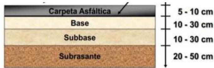
Ilustración 4 Capas de pavimento flexible.
