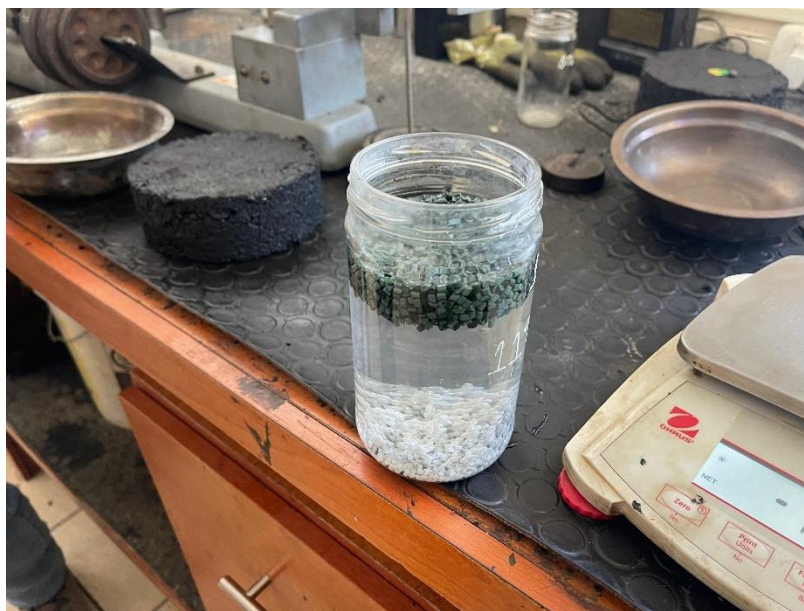
Ilustración 16 Prueba para observar la diferencia de densidades entre PET y PP
