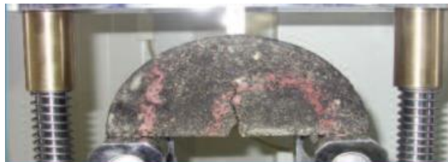
Ilustración 11 Probeta durante el ensayo SCB.
