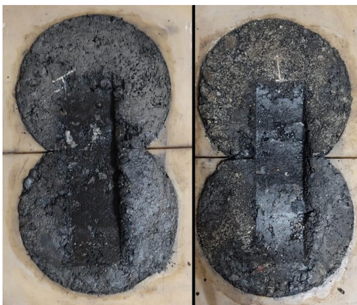
Ilustración 18 Probetas de MAC con 1.5% de PET al finalizar la Rueda de Hamburgo.
