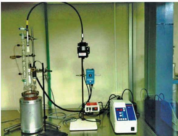
Gráfica 4. Equipo de transesterificación "escala de banca" (bench scale)
