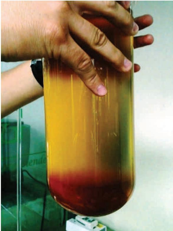
Gráfica 9. Separación de fases en el reactor al finalizar la reacción
