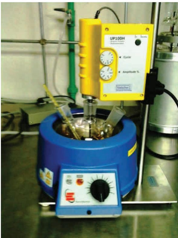
Gráfica 3. Reactor de transesterificación con probeta de ultrasonido en donde se llevaron a cabo las pruebas del diseño factorial <sup>23</sup>
