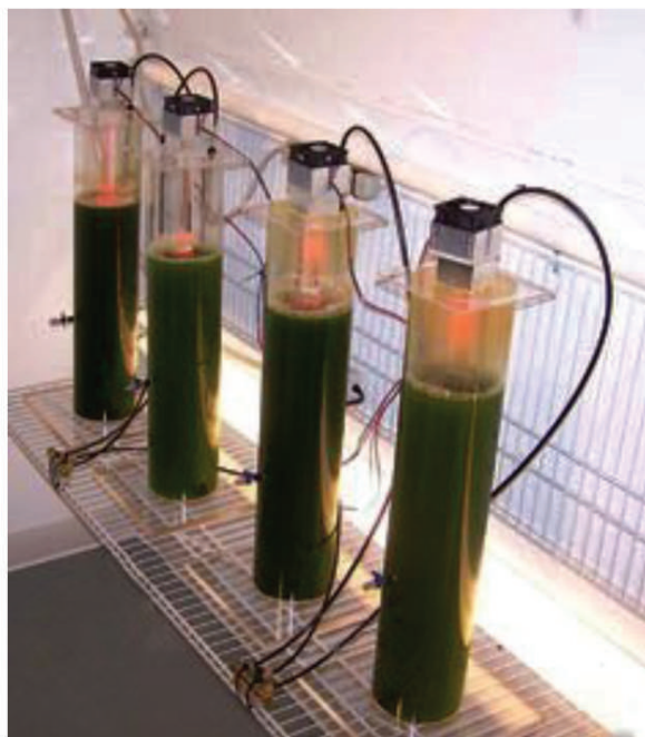
Gráfica 6. Columnas piloto de burbujeo para el crecimiento mixotrófico de algas y cianobacterias (BioVantage Resources)
