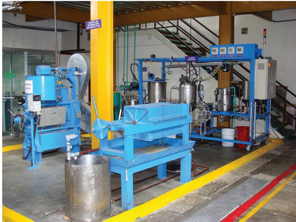
Gráfica 3. Prensa de tornillo y filtro prensa adaptados a la planta de biodiésel de segunda generación
