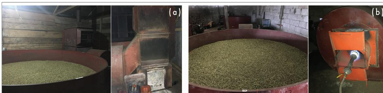
Figura 1. Secador tradicional de leña (a) y secador adaptado con gas (b).
