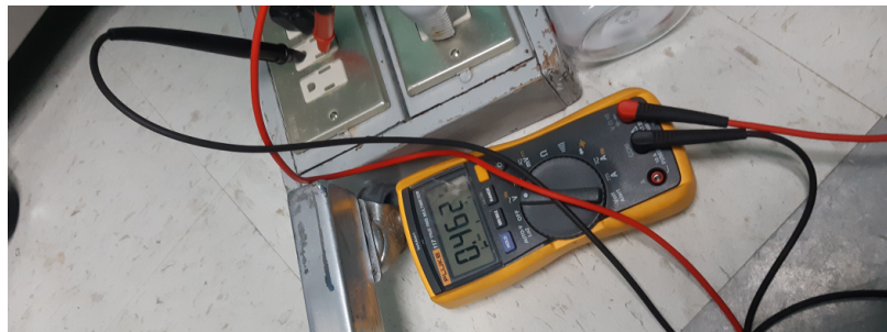
Figura 32: Sala Quirófano B6 regleta polaridad invertida
