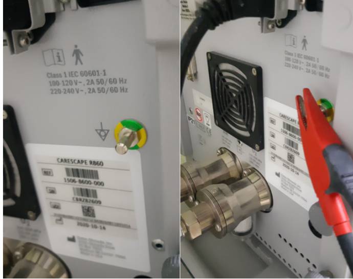
Figura 41: Medición de equipotencialidad
