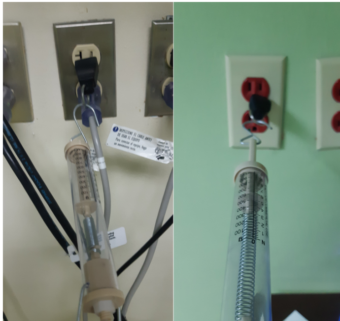
Figura 42: Medición de sujeción
