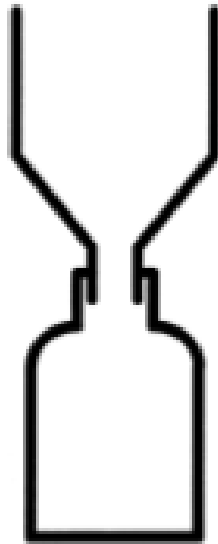
Figura 13. Muestreador para colecta de deposición húmeda y seca colocado directamente sobre la botella colectora. Se puede conectar el embudo con una manguera tipo Tygon (resistente a la corrosión) y colocar el embudo a una distancia de 75 cm, asegurándolo a una superficie.
