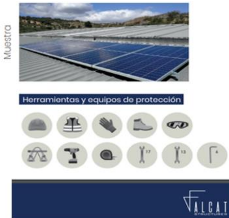
Ilustración 73. Herramientas y equipo de protección recomendado para la instalación de estructuras fotovoltaicas
