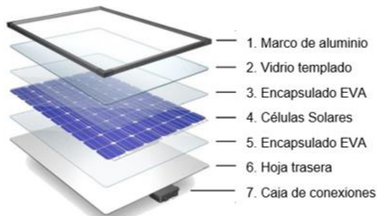
Ilustración 7. Partes de un panel fotovoltaico
