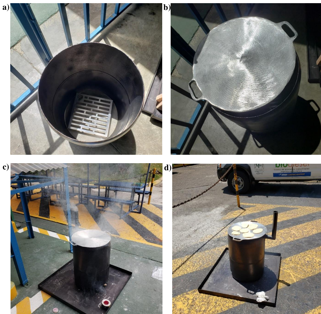
Fotografías tomadas en Laboratorio de operaciones unitarias Ingeniería Química UVG, sobre: a) Vista de planta con rejilla introducida. b) Posicionamiento de comal en sección superior. c) y d) Estufa en funcionamiento con y sin alimento a calentar.
