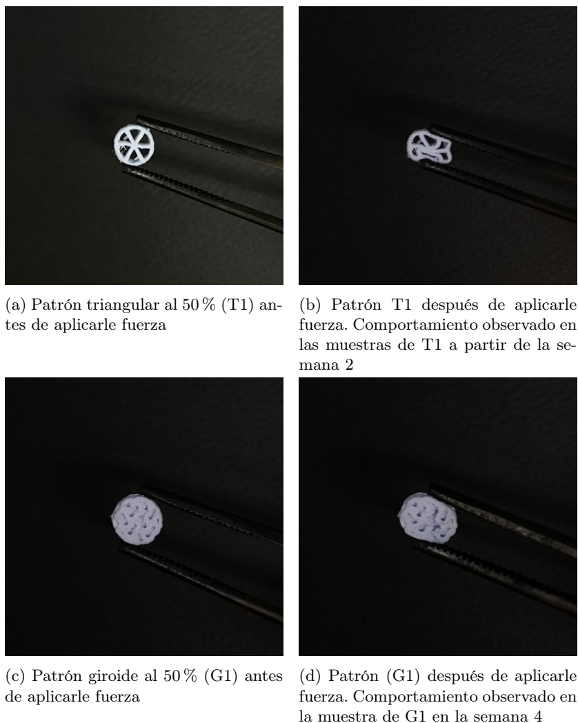
Figura 56: Cambios morfológico en las estructuras T1 y G1 sumergidas en acetona al 99% y tras aplicarle fuerza con pinzas
