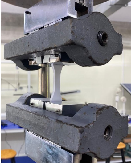
Figura 22: Montaje de las probetas de tracción en la máquina de ensayos universales
