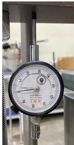
Figura 23: Dial utilizado para leer la deformación de las probetas
