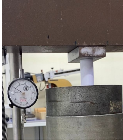
Figura 26: Montaje de las probetas de compresión en la máquina de ensayos universales
