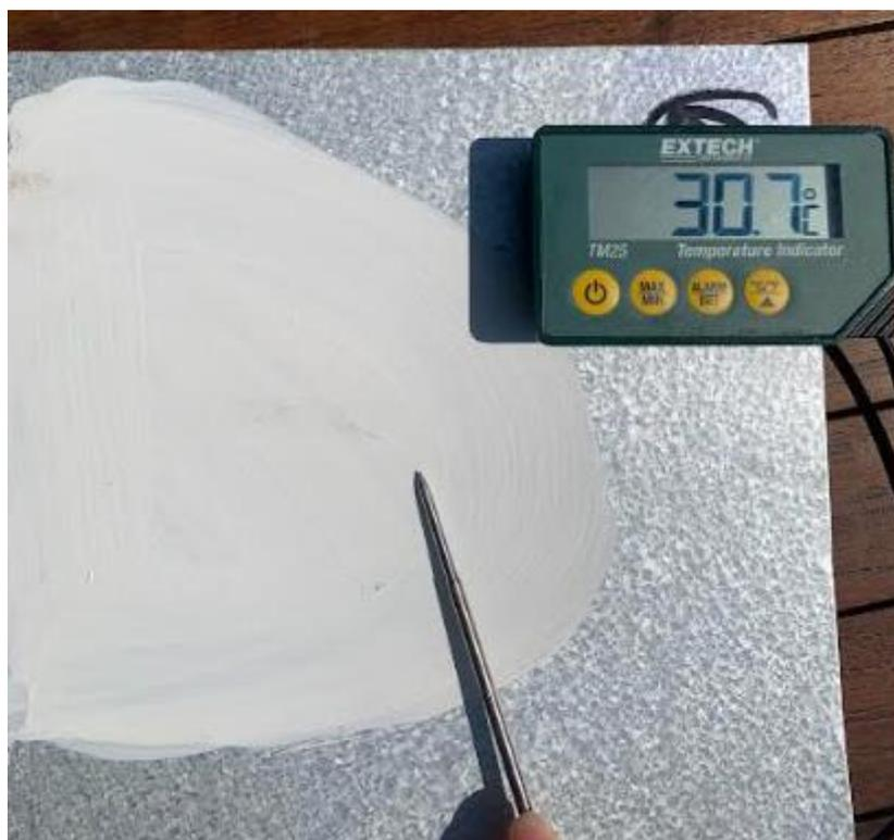
Cuadro No. 34 Medición de temperatura en  $^{\circ}\text{C} \pm 0.05$  de la pintura desarrollada (control 0% de sulfato de bario) en cielo despejado
