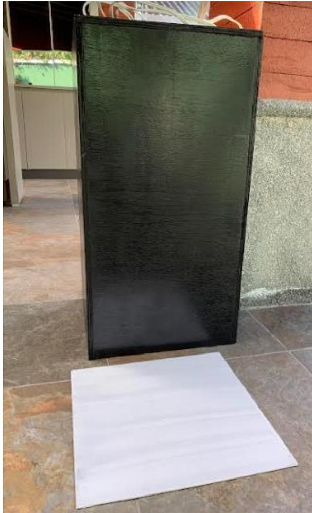
Cuadro No. 45 Medición de temperatura en °C con termómetro láser para determinar emisividad de pintura desarrollada (23.6%)
