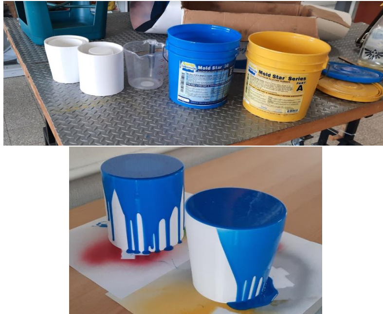
Imagen 23. Molde prototipo elaborado a partir de MoldStar
