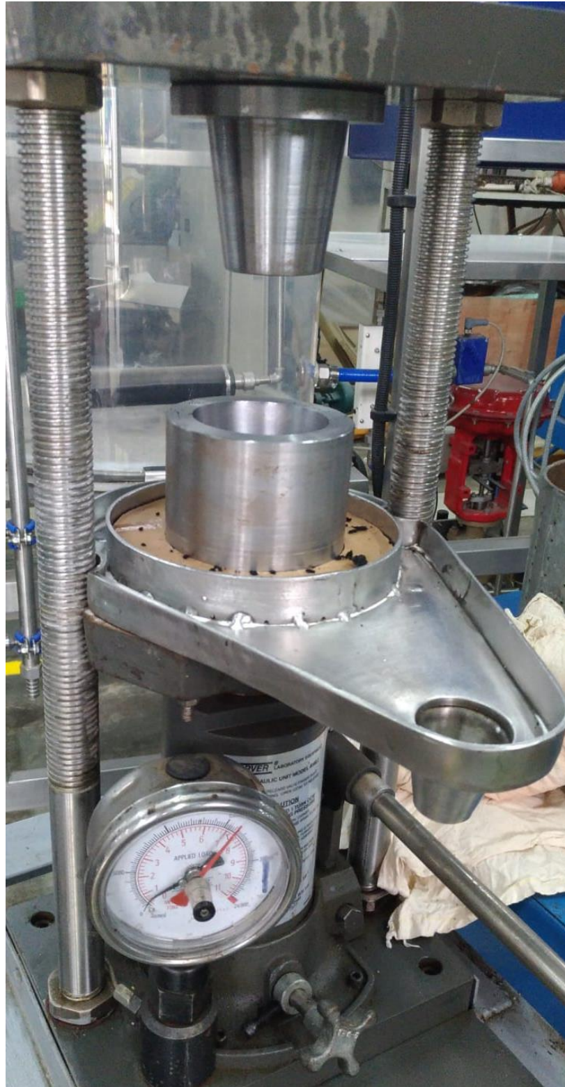
Imagen 27. Proceso de elaboración del vaso en prensa hidráulica
