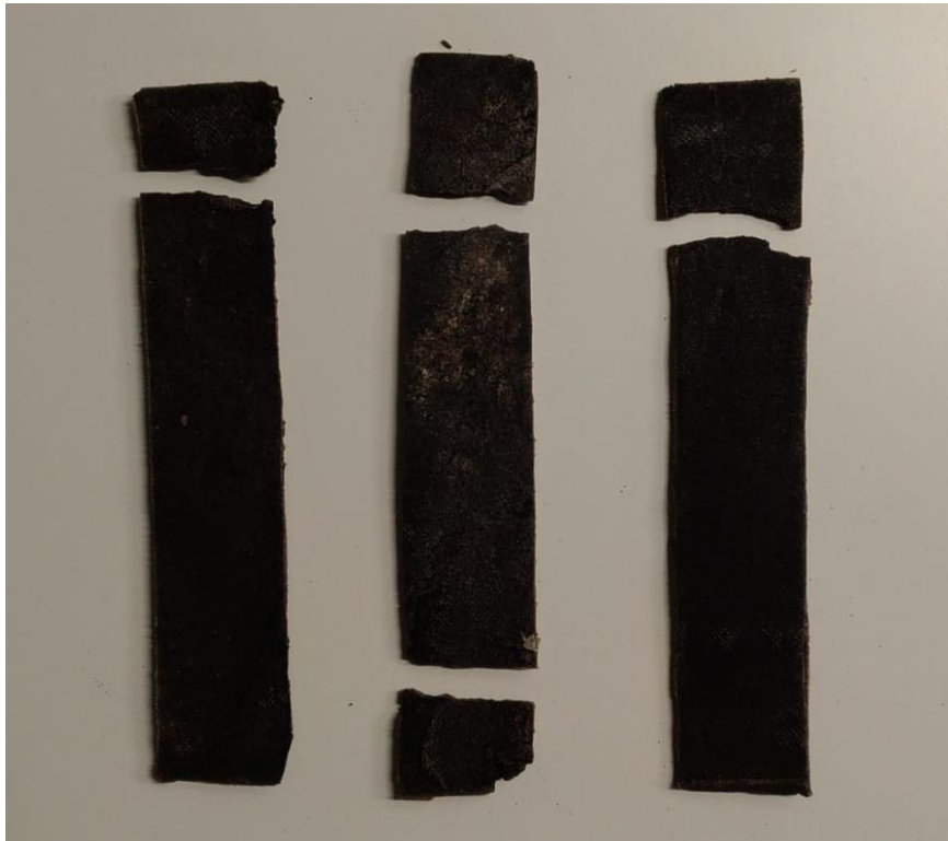
Imagen 36. Lugar de ruptura de piezas utilizadas para análisis de tensión
