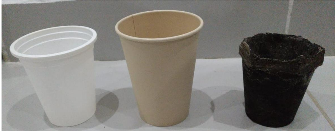
Imagen 39. Comparación de vasos fabricados a partir de chingaste de café y PLA con vasos a partir de bambú y fécula de maíz
