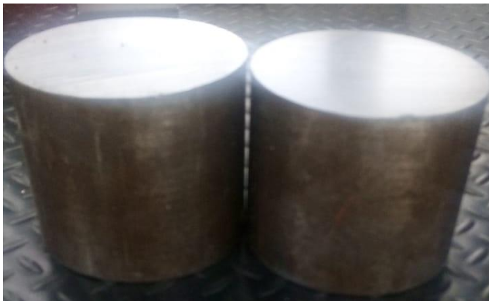
Imagen 24. Acero 10/43 utilizado para la elaboración del molde por medio de un CNC
