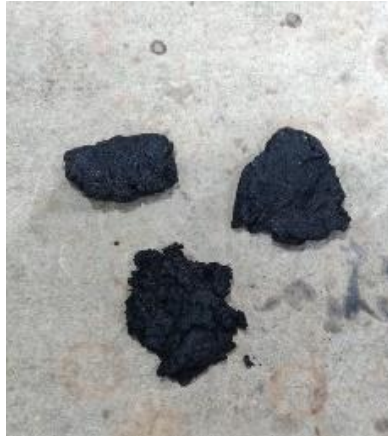
Imagen 28. Muestras elaboradas a partir de mezcla de chingaste de café y PLA con un tamaño de partícula de 0.707 mm (mesh 25), 0.354 mm (mesh 45) y 0.250 mm (mesh 60)
