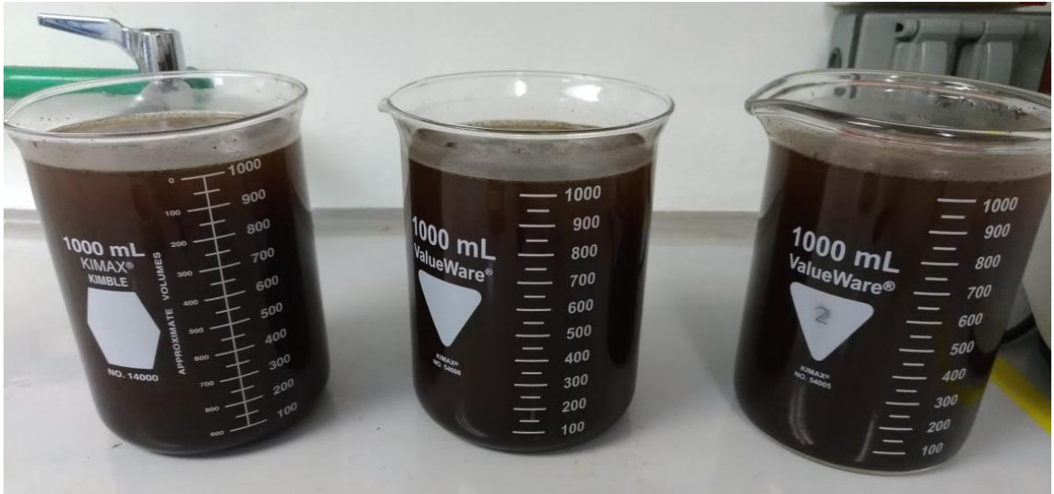
Imagen 30. Lavado de chingaste de café utilizando 1 L de agua destilada durante 24 h
