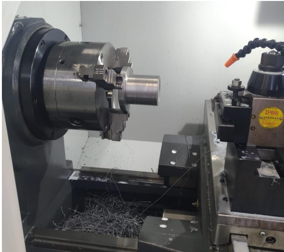
Imagen 25. Proceso realizado en CNC para la elaboración del molde para producir vasos a partir de mezcla de chingaste de café y PLA
