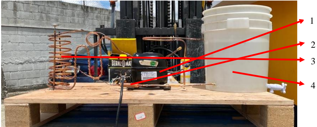
Figura 67. Bomba de calor final con sus componentes y lista para su operación (calentar agua)
