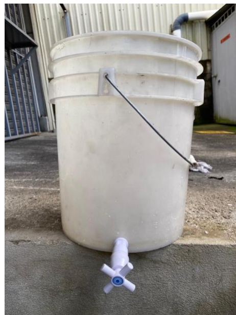
Figura 58. Válvula de 1/4 de vuelta para drenar el contenido de agua que ha sido ingresó a la cubeta
