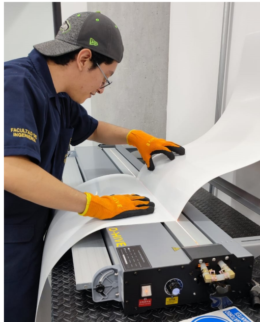
Figura 27: Fabricación de estructura interna
