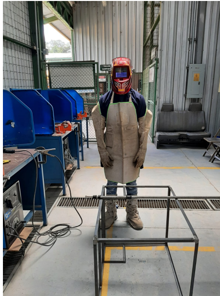
Figura 20: Equipo de protección personal para soldar
