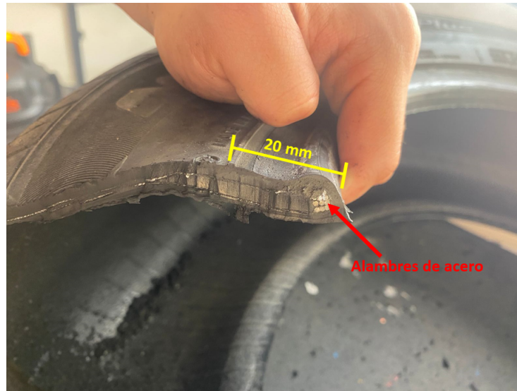
Figura 10: Sección de un neumático de rin 15
