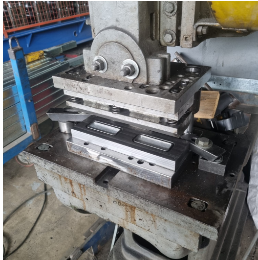
Figura 67: Troquel montado en prensa de Electropuertas
