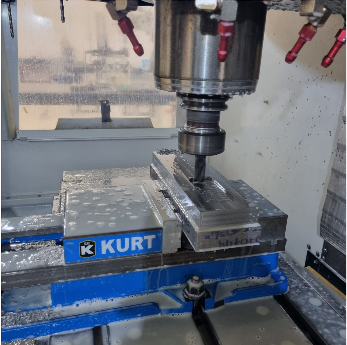
Figura 61: Maquinado de holder
