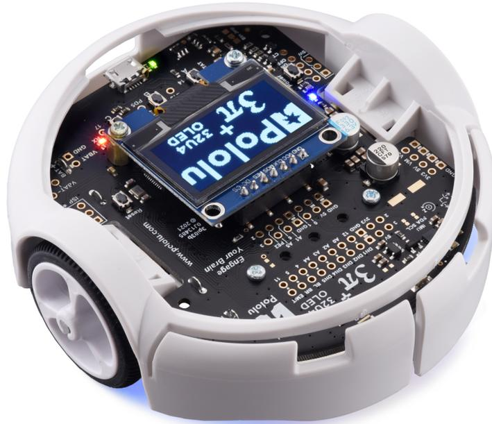
Figura 16: Pololu 3pi+ 32U4 OLED Robot [1].
