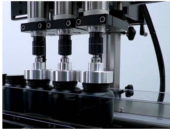
Figura 8: Imagen ilustrativa de proceso de roscado controlado neumáticamente
