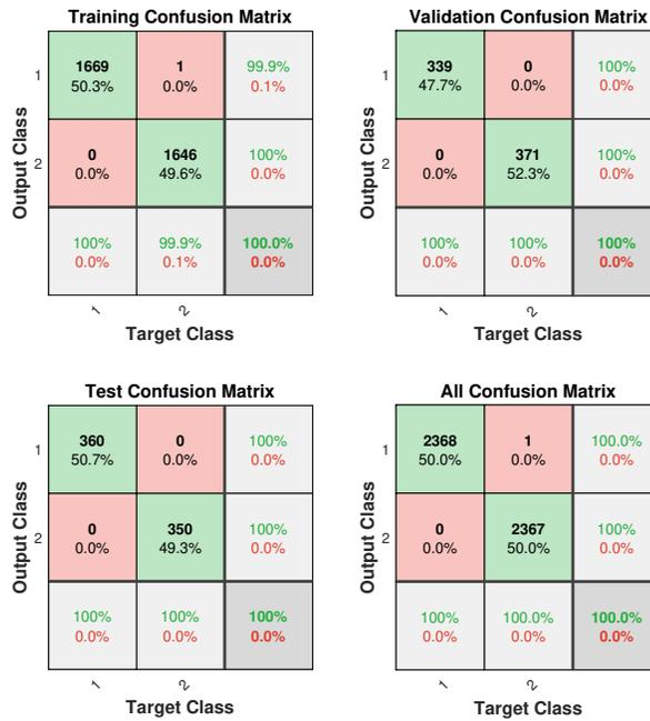
Figura 10: Matriz de confusión para las clases Ictal (1) y Sano (2) con RNA, utilizando las razones 1, 2 y 3 como características en dominio de la frecuencia.
