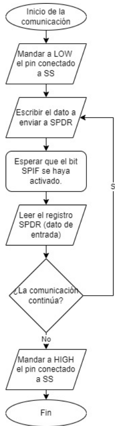
Figura 12: Diagrama de flujo para comunicación por estándar SPI, rol maestro para ATmega328P.
