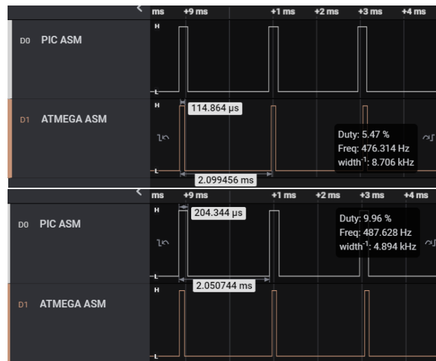
Figura 7: Comparación de respuesta del módulo PWM en ensamblador para PIC16F887 y ATmega328P
