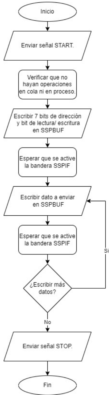
Figura 20: Diagrama de flujo para escritura en Maestro I2C en PIC16F887.
