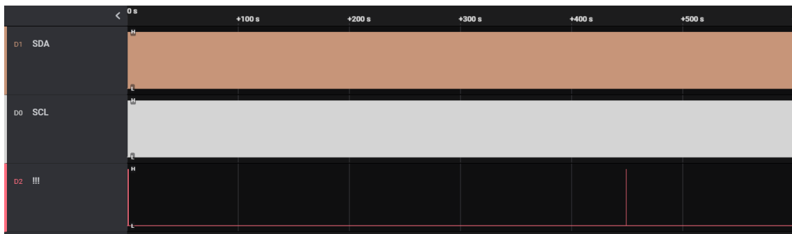
Figura 27: Vista completa de señal de fallo para comunicación I2C en PIC16F887.
