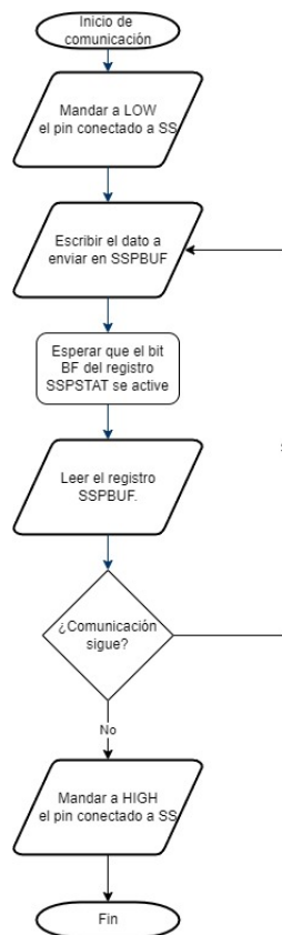
Figura 9: Diagrama de flujo para comunicación por estándar SPI, rol maestro para PIC16F887.
