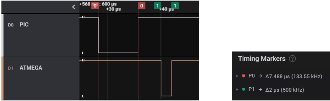
Figura 4: Comparación de tiempo entre lecturas analógicas en ensamblador para PIC16F887 y ATmega328P.
