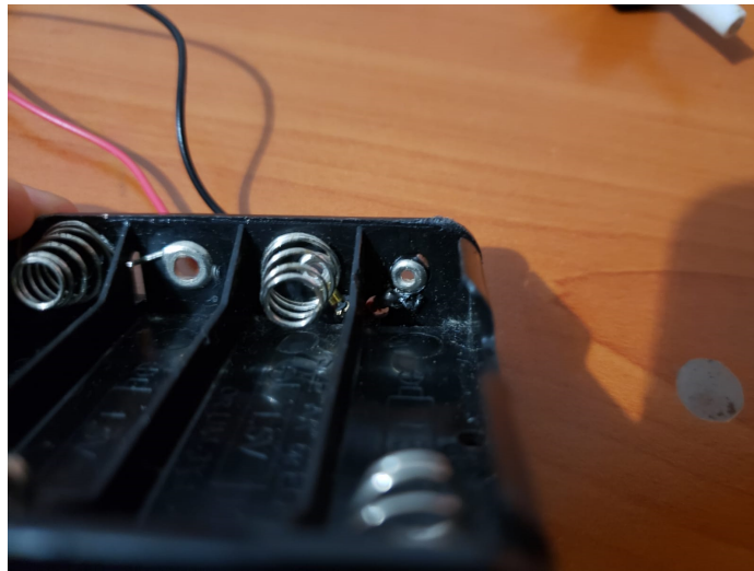
Figura 11: Soldadura de cable de voltaje positivo de la Cyton Board al banco de baterías.
