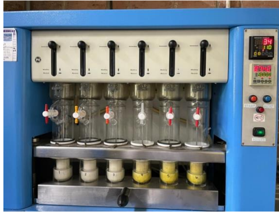
Figura 22. Método de Soxhlet utilizado para la determinación del contenido de grasa en harina de banano verde
