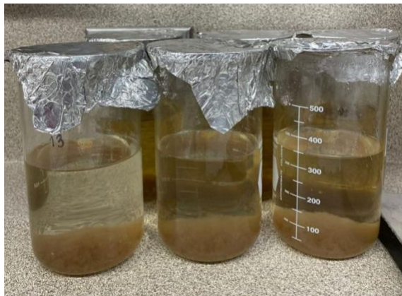
Figura 27. Proceso para determinación del contenido de fibra dietética en harina de banana verde
