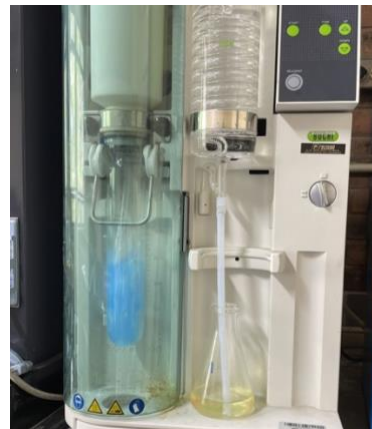
Figura 24. Continuación del Método Kjeldahl para la determinación del contenido de proteína en harina de banano verde
