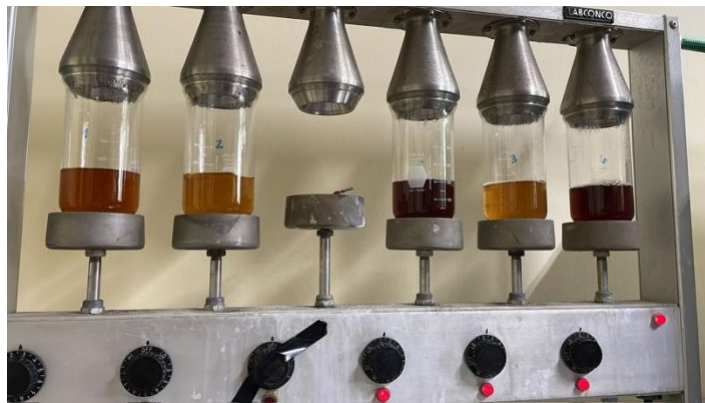
Figura 27. Proceso para determinación del contenido de fibra dietética en harina de banana verde
