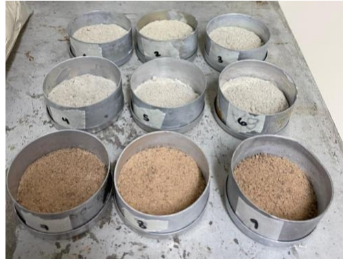
Figura 20. Calcinación de muestras de harina de banano verde para determinación del contenido de ceniza
