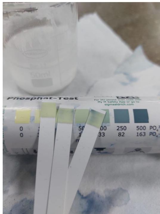
Figura No.7 – Muestra analizada con el kit de campo en el rango de 25-50 ppm
