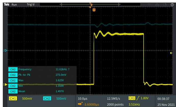
Figura 49: Respuesta a la señal PWM Oscoscopio LQI.
