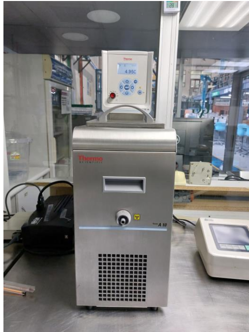
Figura 58: Baño térmico ThermoScientific utilizado para el análisis de densidad vs temperatura
