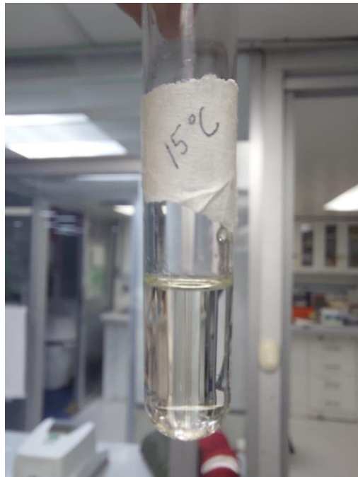
Figura 67: Muestra de aceite de cardamomo enfriada a 13°C en el baño térmico
