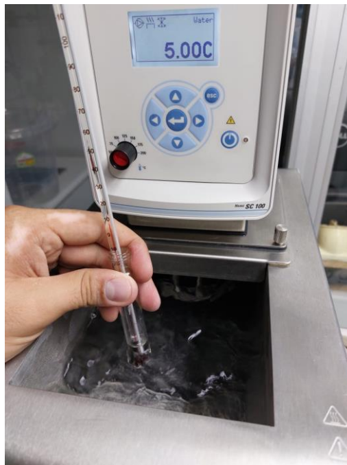
Figura 61: Metodología de enfriamiento de las muestras en tubos de ensayo
