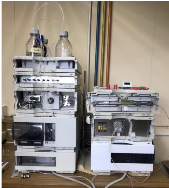
Figura 33: Equipo para el análisis de HPLC realizado en el laboratorio de química de la Universidad del Valle de Guatemala.
