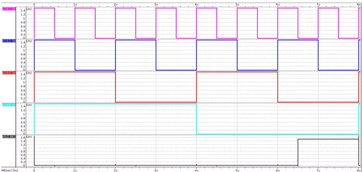
Figura 6: Resultados de la simulación del circuito AOI211D1BWP7T realizado en HSPICE.
