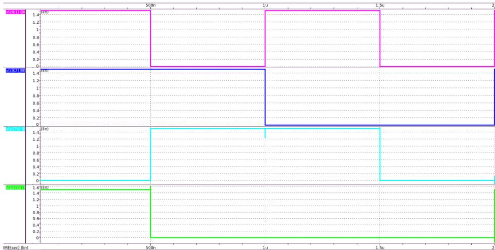
Figura 20: Resultados de la simulación del circuito HA1D0BWP7T realizado en HSPICE.
