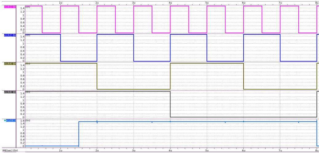
Figura 22: Resultados de la simulación del circuito OAI211D0BWP7T realizado en HSPICE.
