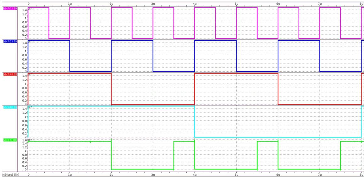
Figura 15: Resultados de la simulación del circuito MOAI22D0BWP7T realizado en HSPICE.
