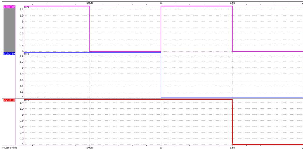
Figura 19: Resultados de la simulación del circuito OR2D1BWP7T realizado en HSPICE.
