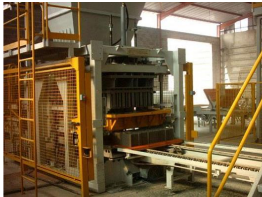
Ilustración 10. Máquina española Poyatos para fabricación de block. Imagen obtenida de http://www.pascualblanch.com/images/maquinaria/POYATOS/universal.jpg
