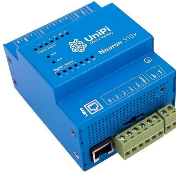
Ilustración 19. Imagen de la UniPi Neuron S10X, una mini computadora industrial con protección IP20. Imagen obtenida de https://www.unipi.technology/upload/produktv/Neuron/Neuron_S10x-side.jpg
