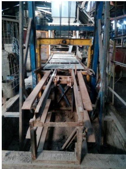
Ilustración 24. Muestra cómo se mueven las tablas dentro de la línea de producción.
