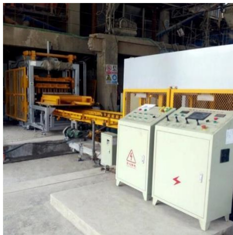
Ilustración 11. Máquina china Qunfeng para fabricación de block. Imagen obtenida de http://image.made-in-china.com/2f0j10unQaeLPGJcqv/Qunfeng-Block-Machine-Brick-Ma.jpg
