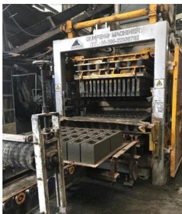
Ilustración 3. Imagen capturada con la máquina en funcionamiento produciendo el block de 15x20x40. Imagen brindada por administración de Rey Block S.A.
