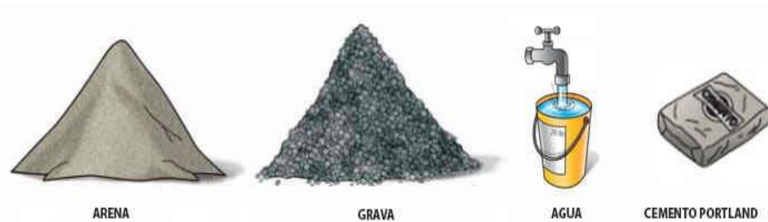
Ilustración 6. Materia prima utilizada para fabricar bloques de cemento. Imagen obtenida de https://bloqueras.org/bloques-concreto/
