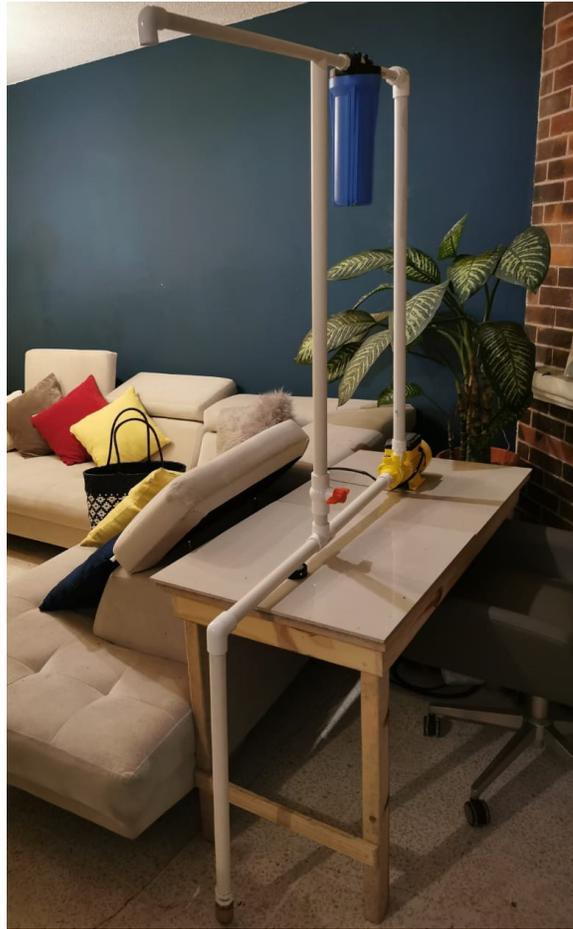
Para finalizar el proceso, se añadió un metro de tubo hacia abajo para la tubería de succión un con una válvula de retención con un adaptador macho para restringir el flujo de agua en una sola vía.
