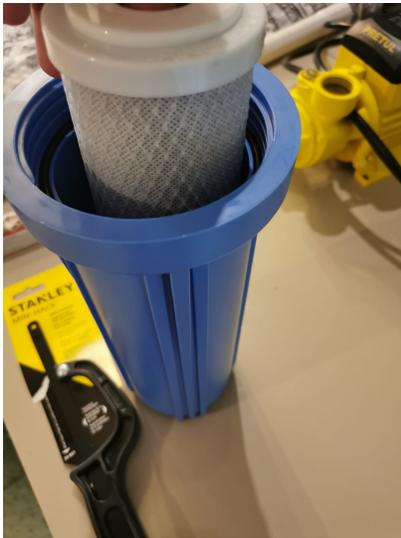
Figura 26: Housing con adaptadores en los extremos de 1/2"
