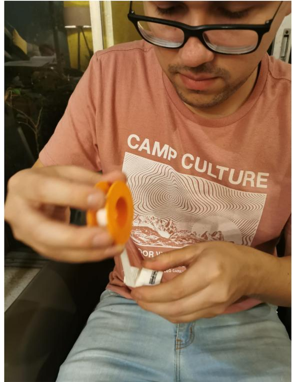
Posterior a ello se introdujo el primer adaptador macho en la succión de la bomba, para luego introducir un metro de tubo del mismo diámetro para poder realizar un cambio de diámetro cuando el fluido se comporta de forma laminar. Después, se incorporó un codo de 90° con un reductor de tamaño de 1" a  $\frac{1}{2}$ ", la cual serviría para instalar el housing con dicha medida para la entrada y salida.
