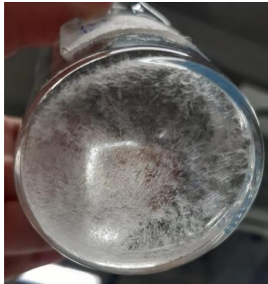
Figura 49. Cristales recuperados de la filtración al vacío posterior al proceso de extracción y purificación.
