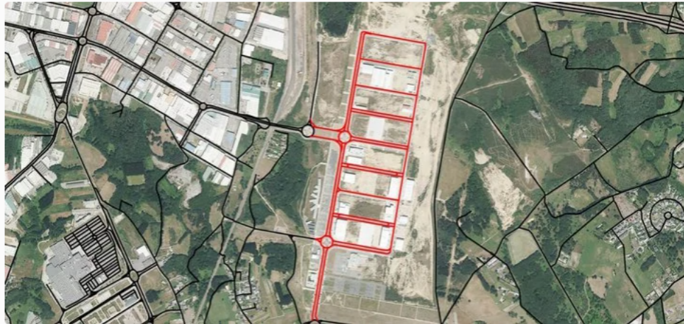
Figura 26. Representación de una red de carreteras almacenadas en fichero shapefile y ampliación de la misma mediante entidades de dibujo nativas de AutoCAD sobre una ortofotografía aérea.
