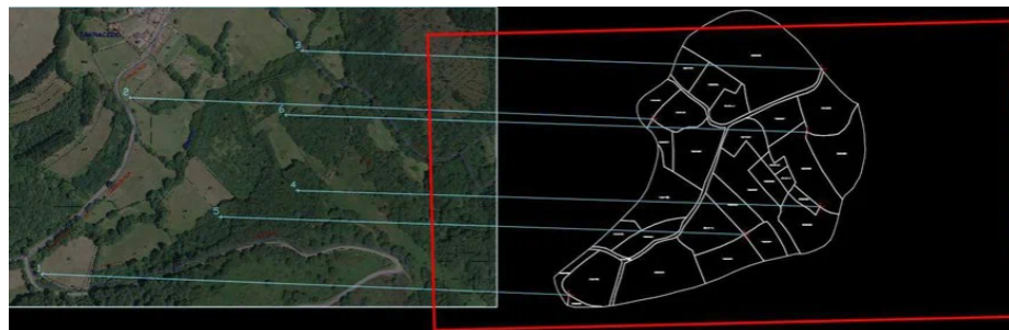
Figura 29. Georreferenciación de una imagen ráster en base a un conjunto de entidades CAD
