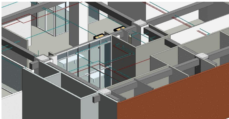
Figura 36. Vista isométrica sistema hidráulico en laboratorios
