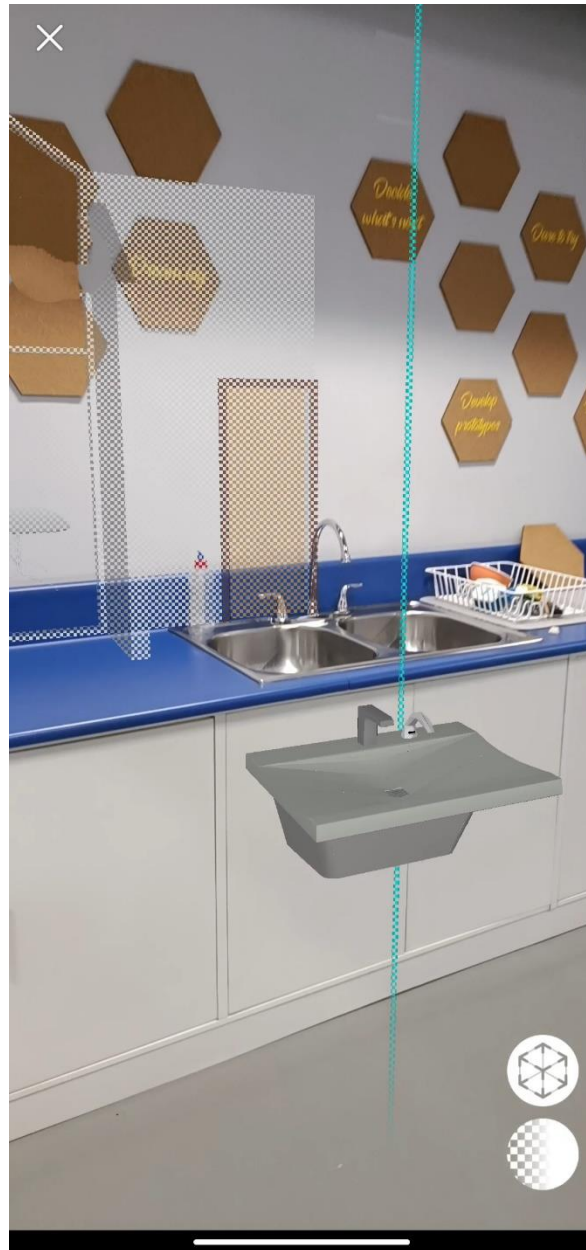
Figura 65. Desfase de vinculación por movimiento
