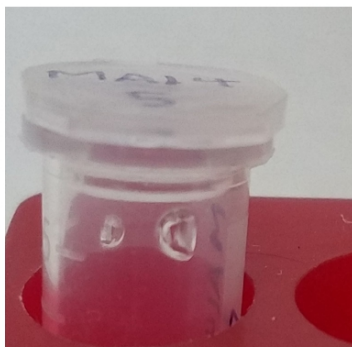
Figura 2. Vial de 2 mL perforado de cada lado para el almacenamiento de mosquitos.
