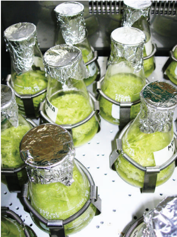
Gráfico 1. Extracción y fermentación simultáneas del azúcar contenido en partículas del tallo de sorgo dulce suspendidas en agua
