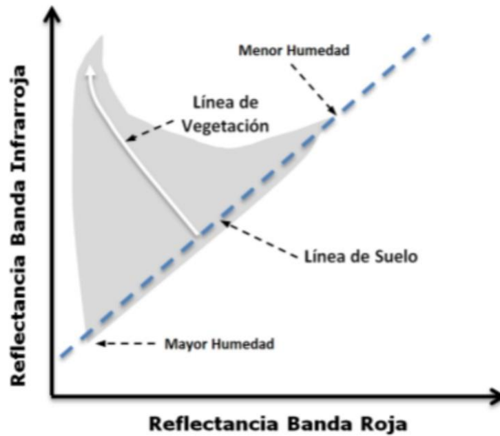
Figura 26. Comportamiento de la reflectancia de la banda infrarroja contra la banda roja (Aguayo, 2013)
