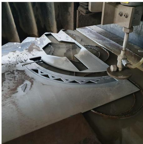
Figura 38: Proceso de hidrocorte de aluminio.
