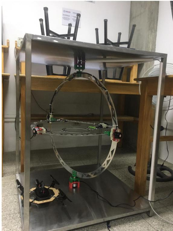
Figura 52: Plataforma de pruebas para quadcopters
