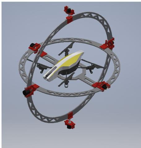
Figura 26: Ensamble 3D del primer diseño de prototipo para la plataforma de pruebas Parrot AR 2.0
