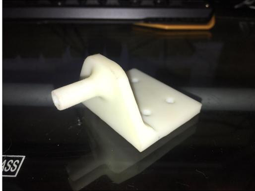
Figura 35: Receptor para eje de cabeceo maquinado en ertalon.
