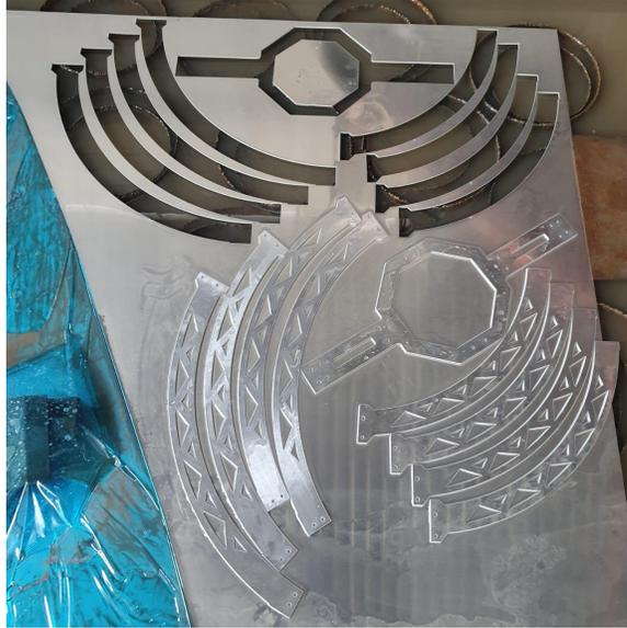
Figura 39: Aros y plataforma central en aluminio 2 mm.
