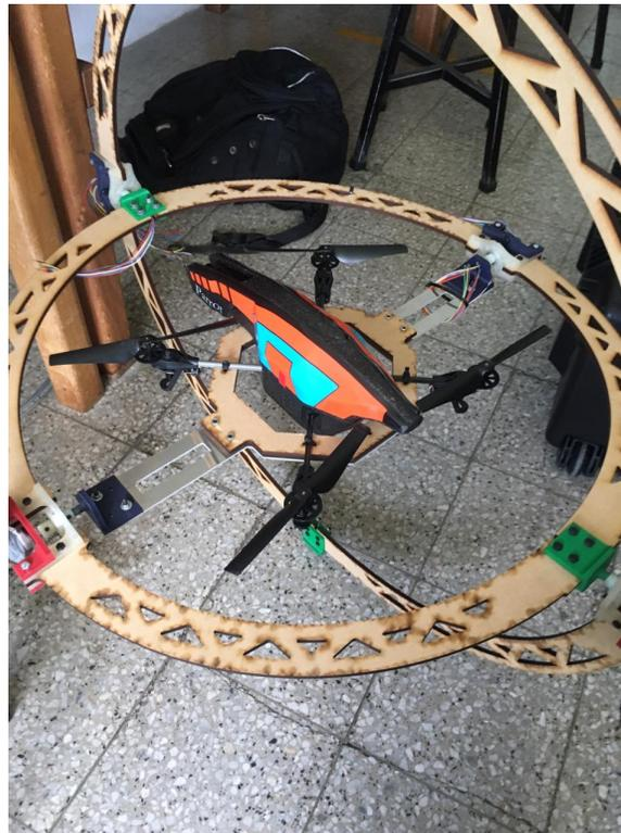
Figura 46: Segundo prototipo de plataforma de pruebas con quadcopter Parrot AR 2.0
