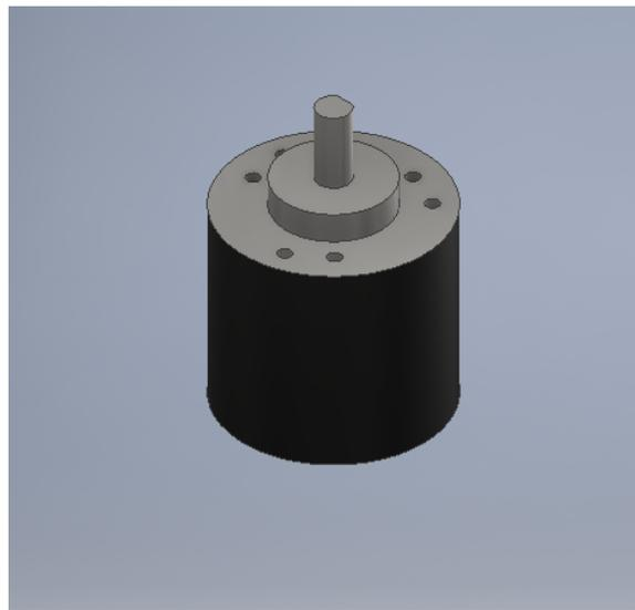
Figura 11: Modelo 3D del codificador rotacional LPD3806-600BM.
