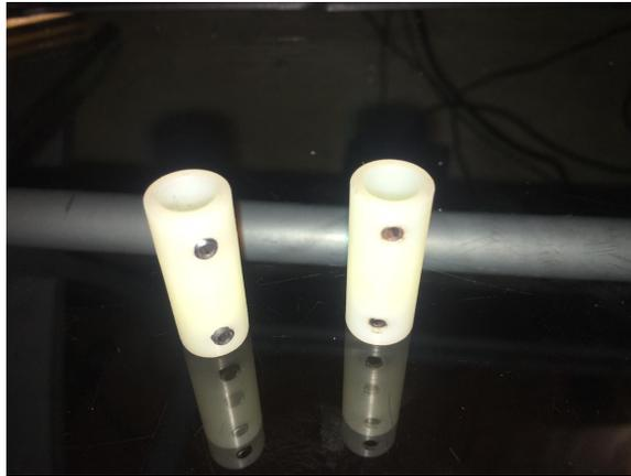
Figura 44: Acopladores de Ertalon. Acoplador de anillo colector en la izquierda, acoplador de codificador en la derecha.
