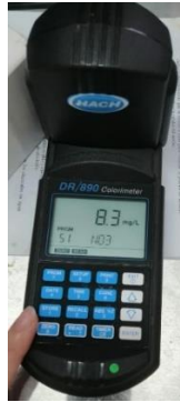
Figura 90. Equipo HACH DR890 utilizado para la cuantificación de nitratos en el medio de cultivo
