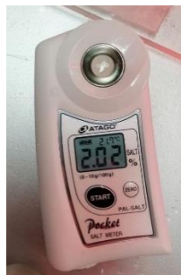
Figura 91. Medidor salino ATAGO utilizado para cuantificar el porcentaje de salinidad en el medio de cultivo
