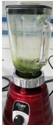
Figura 76. Lisis celular inducida con estrés mecánico por licuadora de la biomasa recuperada
