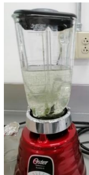
Figura 80. Muestra de cultivo de microalgas previo a la lisis celular por estrés mecánico con licuadora
