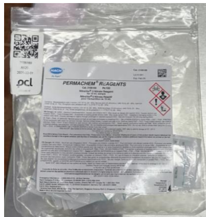
Figura 65. Sobres NitraVer 5 Nitrate Reagent para la cuantificación de nitratos con el equipo HACH DR 890
