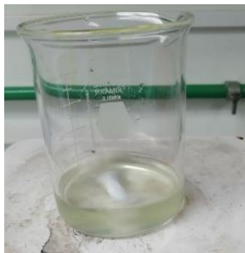
Figura 84. Muestra de microalgas sometida a lisis celular por hidrólisis ácida con ácido clorhídrico
