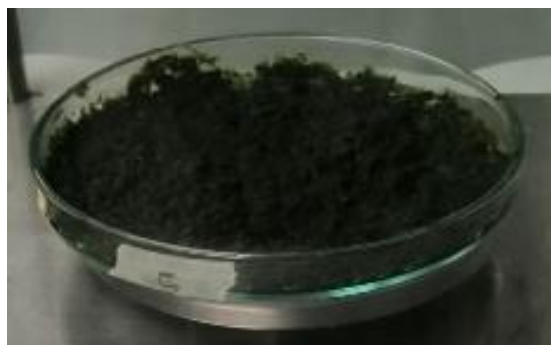
Figura 85. Biomasa seca utilizada en los métodos de extracción de aceite con solventes
