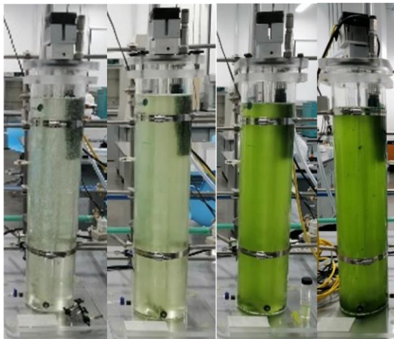
Figura 32. Cambio en el tiempo del cultivo de microalgas N. oculata en fotobiorreactores de columna de burbuja ascendente de 8 L a una concentración inicial de la fuente de nitrógeno x0.10
