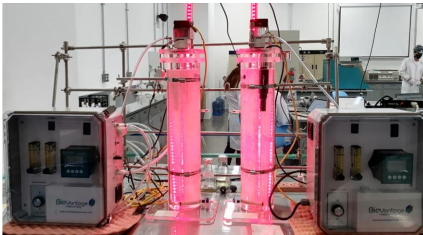
Figura 27. Sistema de dos fotobiorreactores de columna de burbuja ascendente de 8 L marca Biovantage utilizado para las fermentaciones
