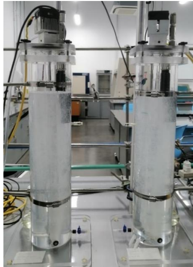
Figura 28. Fotobiorreactores de columna de burbuja ascendente de 8 L con 5 L de medio de cultivo f/2 Guillard modificado
