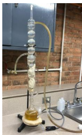
Figura 50: Sistema utilizado para la extracción por solventes de aceite esencial y agua floral de semilla de cardamomo y resina de copal
