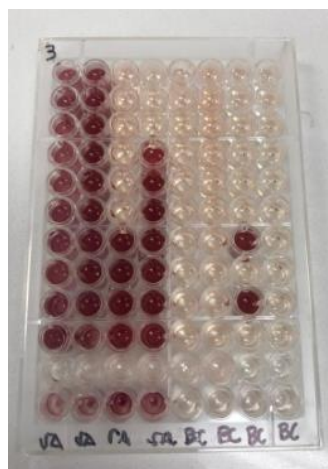
Figura 61: Placa ELISA utilizada para la evaluación de la capacidad antimicrobiana de las muestras de aceite esencial y agua floral de cardamomo y aceite resina de copal contra S. aureus y B. cereus
