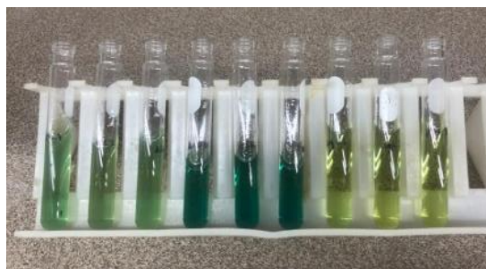
Figura 56: Muestras de aceite esencial de cardamomo, aceite esencial de resina de copal y agua floral de cardamomo tras el análisis de antioxidantes FRAP
