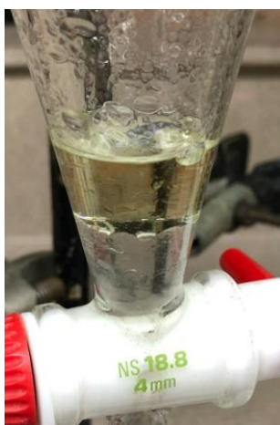
Figura 49: Proceso de decantación para la separación del aceite esencial y agua floral de resina de copal obtenidas por el método de arrastre de vapor
