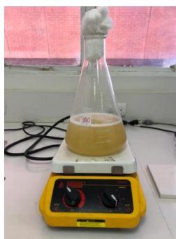
Figura 57: Preparación de medio de cultivo Mueller Hilton para el análisis de capacidad antimicrobiana en muestras de aceite esencial y agua floral de cardamomo y aceite resina de copal
