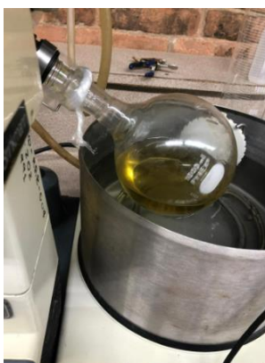
Figura 52: Rotavapor utilizado para la separación de aceite esencial de cardamomo y hexano tras la extracción por el método de solventes
