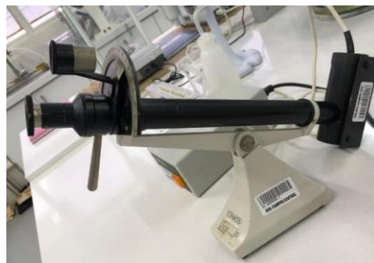
Figura 54: Polarímetro utilizado para la medición de rotación óptica de los aceites esenciales y aguas florales extraídas por arrastre de vapor
