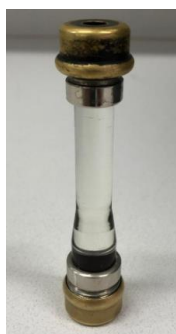
Figura 55: Tubo óptico utilizado para la medición de rotación óptica de los aceites esenciales y aguas florales extraídas por arrastre de vapor
