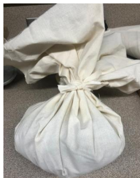
Figura 44: Bolsa de manta armada para introducir la muestra en el alambique de acero inoxidable para la extracción por arrastre de vapor
