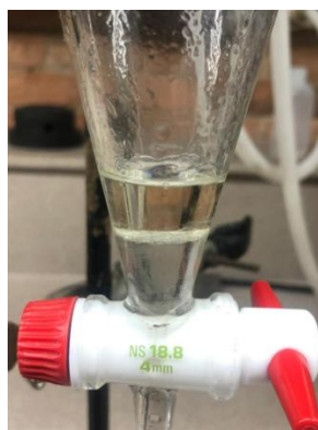
Figura 47: Proceso de decantación para la separación del aceite esencial y agua floral de cardamomo obtenidas por el método de arrastre de vapor
