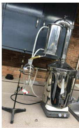
Figura 45: Alambique de acero inoxidable y sistema utilizado para la extracción por arrastre de vapor de aceite esencial y agua floral de semilla de cardamomo y resina de copal
