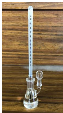
Figura 53: Pícnómetro utilizado para la medición de densidad de los aceites esenciales y aguas florales extraídas por arrastre de vapor
