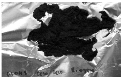
Figura 203. Biomasa en peso seco de la fermentación EtMax (réplica 8).
