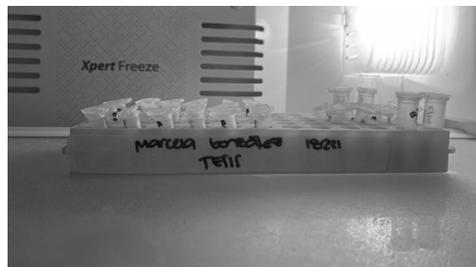
Figura 107. Solución mastermix preparada a partir de buffer, solución NAD y enzima aldehído deshidrogenasa para la cuantificación de acetaldehído en estándares y en el producto final
