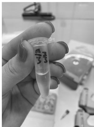
Figura 108. Solución mastermix preparada a partir de buffer y solución NAD para la cuantificación de acetaldehído en el producto final
