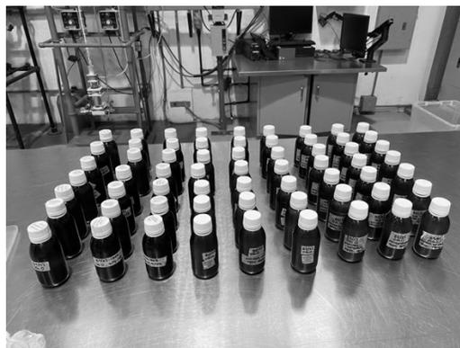
Figura 94. Botellas utilizadas para la recolección del producto final de cada corrida y cada prueba
