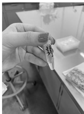
Figura 110. Estándar de acetaldehído 60 $\mu$ M utilizado para la preparación de estándares 0, 18, 36 y 100  $\mu$ M con agua ultrapura
