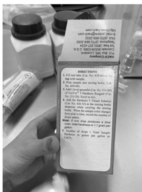
Figura 44. Reactivo EDTA, elemento del kit HACH utilizado para evaluar la dureza del agua
