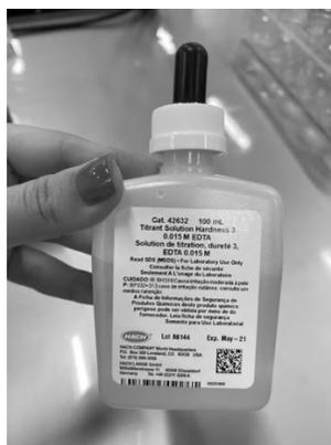
Figura 45. Reactivo de dureza, elemento del kit HACH utilizado para evaluar la dureza del agua
