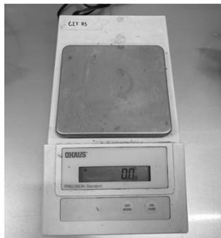
Figura 34. Balanza analítica marca OHAUS utilizada para el pesaje del estándar de betacarotenos
