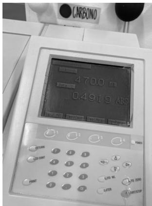
Figura 123. Ejemplo de lectura a 430 nm en espectrofotómetro UV-VIS para determinación de valor SRM en el producto final
