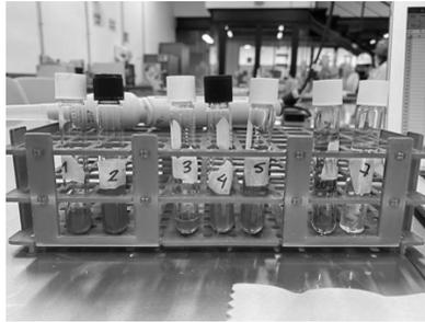
Figura 118. Extracción líquido líquido del  $\beta$ -caroteno presentes en la muestra utilizando acetona y hexano como disolventes
