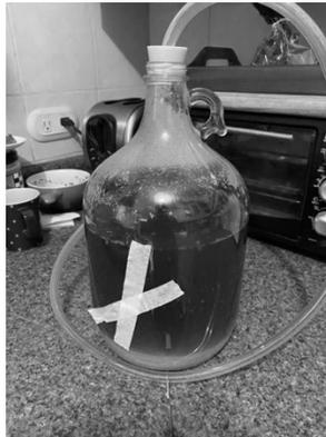
Figura 89. Fermentador luego de la inactivación de *S. cerevisiae* e inoculación de *R. glutinis* (Ejemplo de prueba 2)
