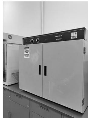
Figura 36. Horno secador marca Symphony utilizado para la cuantificación de peso seco de las levaduras
