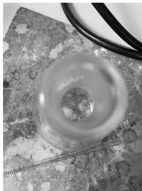
Figura 121. Extracto de  $\beta$ -caroteno diluido en acetonitrilo para su cuantificación
