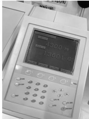
Figura 124. Ejemplo de lectura a 700 nm en espectrofotómetro UV-VIS para determinación de turbidez en el producto final
