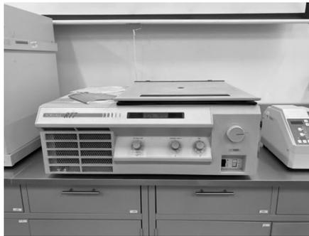
Figura 30. Incubadora con agitación marca Lab. Companion utilizada para la propagación de levaduras a 30°C y 120 rpm
