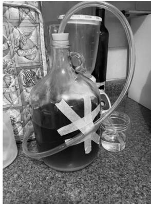
Figura 92. Toma de muestra cada 24 horas utilizando un sifón
