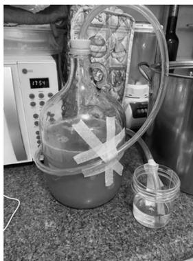
Figura 90. Fermentador 24 horas desde la inoculación de *R. glutinis* (Ejemplo de prueba 2)
