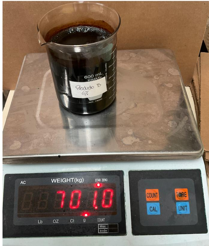
Figura 36. Pesaje del recipiente con producto C antes de agregarle la arcilla abundante en minerales para obtener una concentración al 6% p/p.
