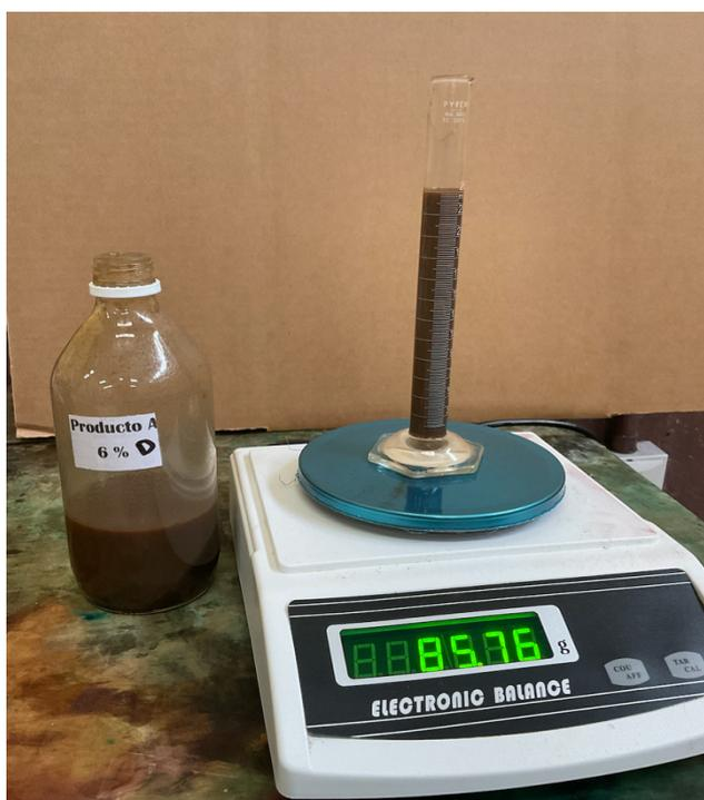
Figura 63. Determinación de la masa de un volumen de 25 mL del producto B que no fue sometido a la prueba de degradación térmica agresiva, utilizando balanza electrónica
