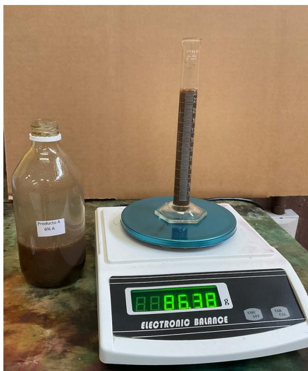
Figura 62. Determinación de la masa de un volumen de 25 mL del producto A que fue sometido a la prueba de degradación térmica agresiva, utilizando balanza electrónica
