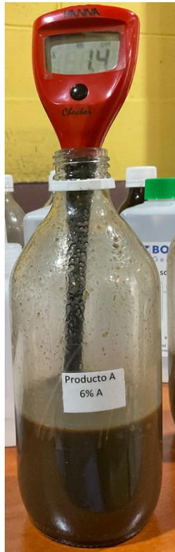
Figura 56. Determinación de pH al recipiente con el producto A, que fue sometido a la prueba de degradación térmica agresiva
