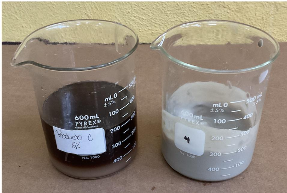
Figura 39. Recipientes con producto C antes de agregarle la arcilla abundante en minerales y solución de arcilla abundante en minerales para obtener una concentración al 6% p/p, vista en elevación
