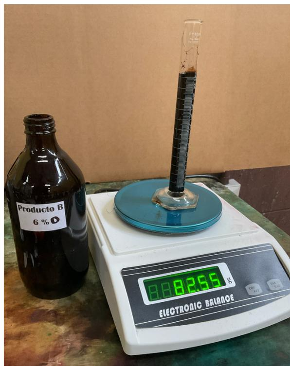
Figura 65. Determinación de la masa de un volumen de 25 mL del producto C que no fue sometido a la prueba de degradación térmica agresiva, utilizando balanza electrónica
