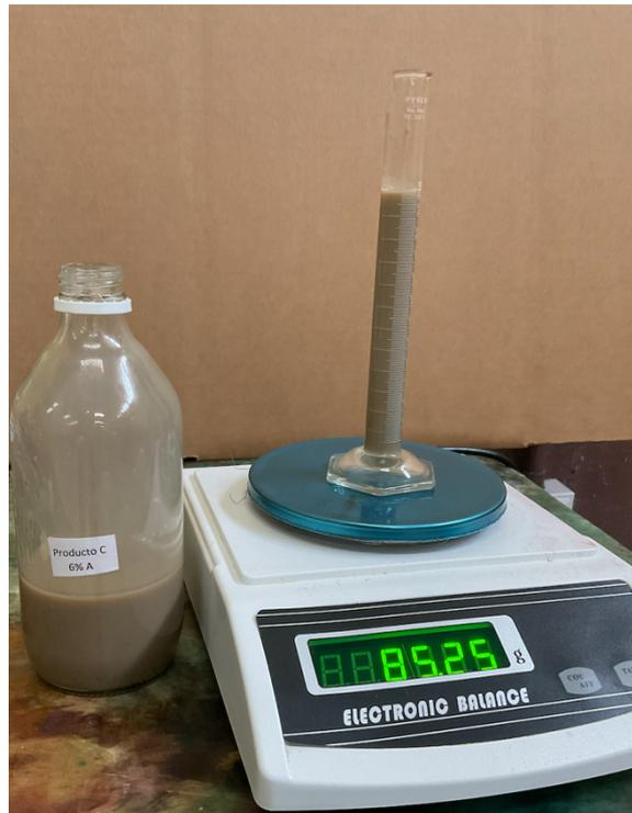
Figura 66. Determinación de la masa de un volumen de 25 mL del producto C que fue sometido a la prueba de degradación térmica agresiva, utilizando balanza electrónica
