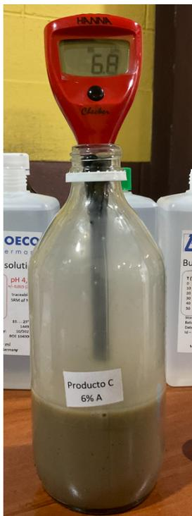
Figura 60. Determinación de pH al recipiente con el producto C, que fue sometido a la prueba de degradación térmica agresiva
