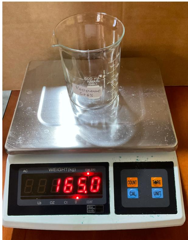
Figura 18. Pesaje del producto A contenido en el recipiente antes de agregar la arcilla para obtener una concentración de 2% p/p.
