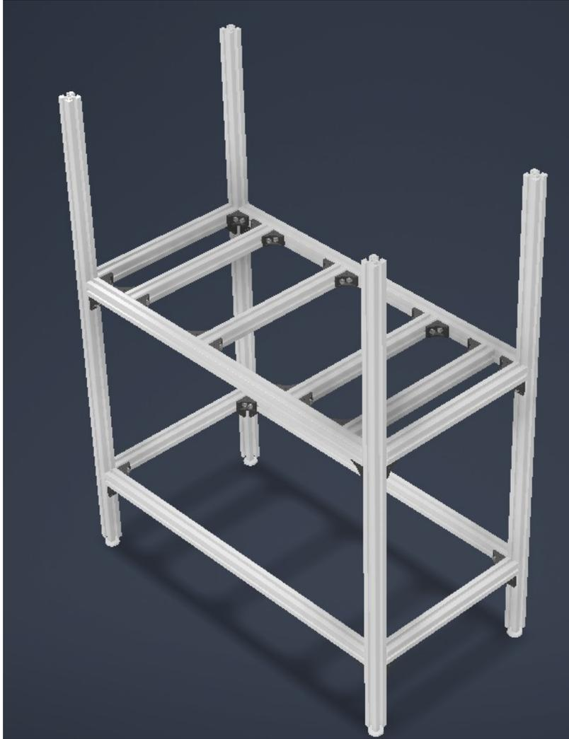
Figura 32: Ensamble de la mesa con sus soportes transversales
