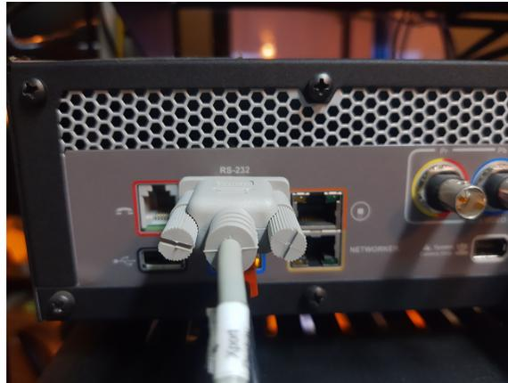
Figura 17.2: Cable de módem nulo conectado al puerto RS-232 del *LifeSize Room 220i*
