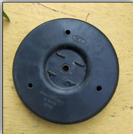
Figura 6: Rotor con el primer juego de agujeros perforados.
