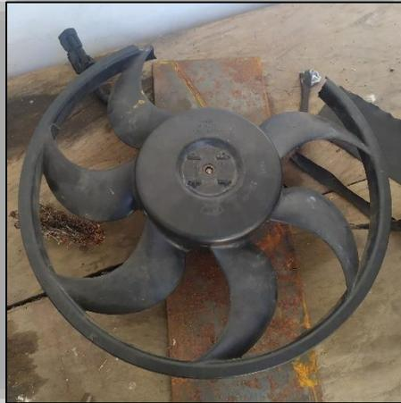
Figura 5:Aspas originales del ventilador para radiador de carro.
