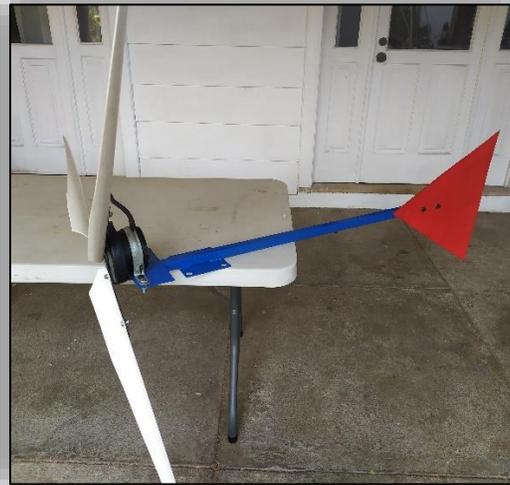
*Figura 28: Ensamble del subensamble del rotor con el subensamble del cuerpo de la turbina.*
