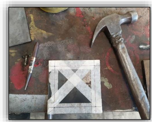
Figura 10: Placa base de la chumacera marcada con tape y los centros de los agujeros marcados con punzón y martillo.
