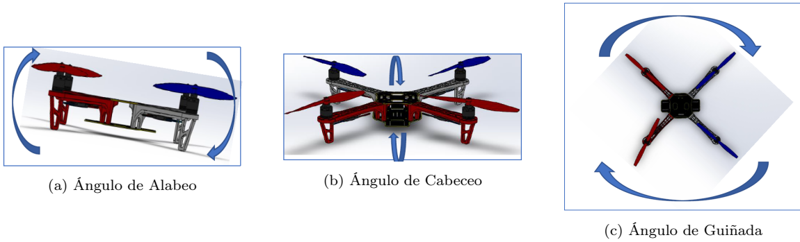
Figura 6: Ángulos de euler en un cuadricóptero [7].
