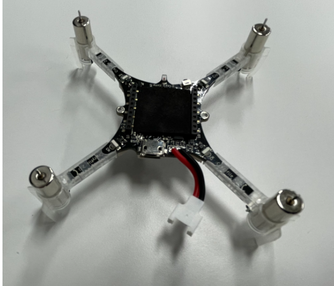
Figura 14: Colocado de motores del Crazyflie 2.0 .
