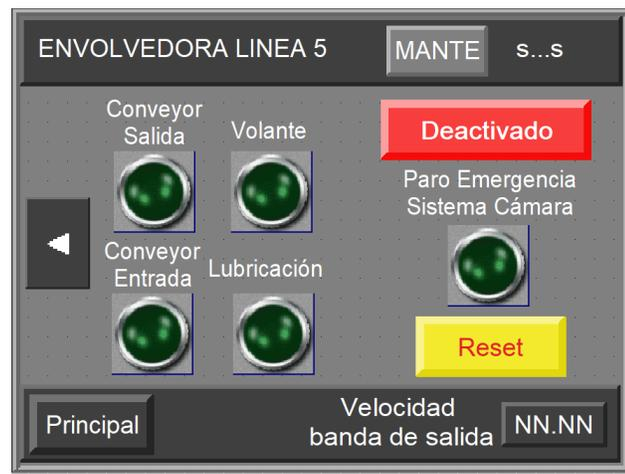
Figura 30: Adición de indicadores y botones en la HMI de la envolvente.
