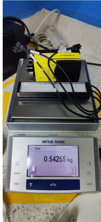
Figura 11: Peso total a sostener por el mecanismo para el equipo OCR.
