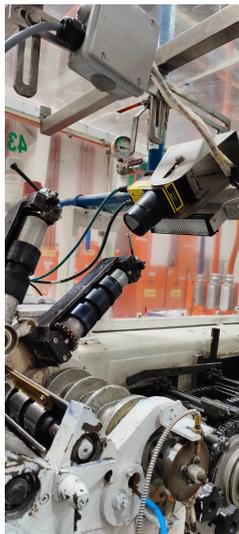
Figura 14: Sistema OCR fuera del área de trabajo.
