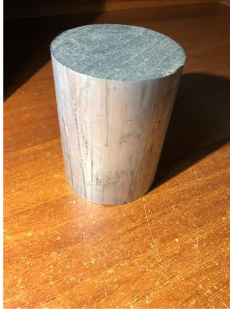
Figura 34: Cilindro de aluminio 6061 para la manufactura del cilindro
