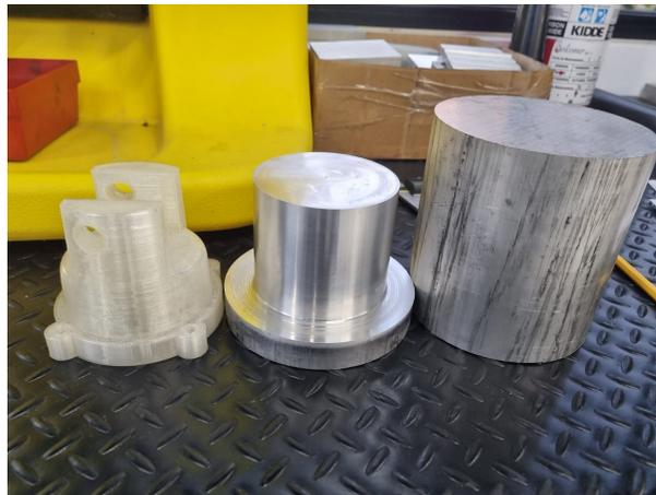
Figura 44: Resultado del refrentado y cilindrado de la tapa de grupo
