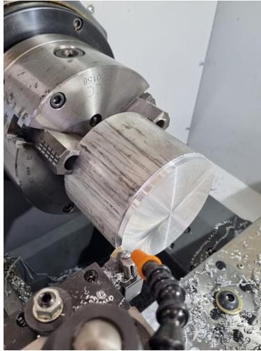
Figura 43: Refrentado y cilindrado de la tapa de grupo
