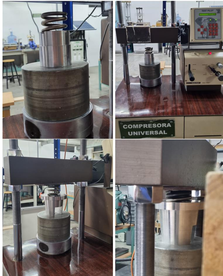
Figura 75: Prueba para obtención de la constante de compresión del resorte
