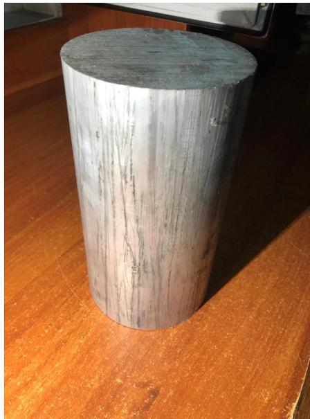
Figura 33: Cilindro de aluminio 6061 para la manufactura del grupo y guía del porta filtro.
