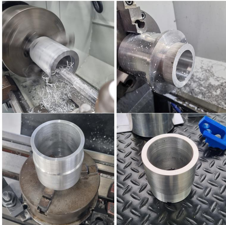
Figura 54: Fabricación del cilindro para el grupo
