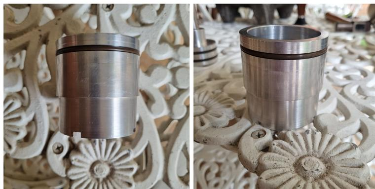
Figura 55: Cilindro con empaques instalados
