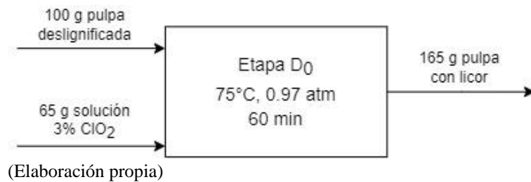
Figura 16. Detalle de los flujos de entrada y salida del balance de masa de la etapa D 0 del blanqueo con el método ECF
