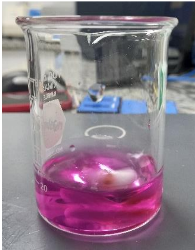
Figura 25. Muestra de pulpa deslignificada en solución de permanganato de potasio y ácido sulfúrico para determinar el número Kappa
